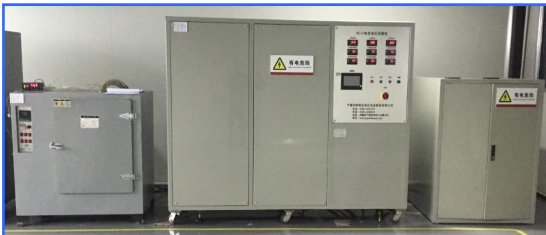
直流耐久性试验台 DC endurance test machine
