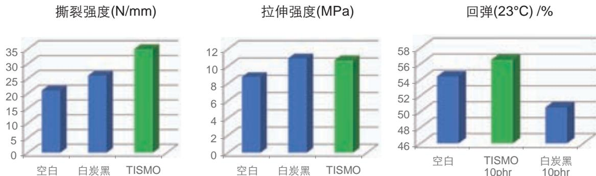
在硅橡胶中用低剪切混炼工艺填充TISMO，能够大幅提高橡胶的抗撕裂性能，同时保持硅橡胶的高弹性，提高硅橡胶耐热老化性能，其性能明显优于传统的白炭黑填料。TISMO高填充时能够进一步提高硅橡胶的耐高温老化性能，建议用量在5~30phr。在普通沉淀法硅橡胶中添加TISMO，能够制成高抗撕裂，且高弹性的硅橡胶产品，也可用于制作耐苛刻温度的硅橡胶制品。
