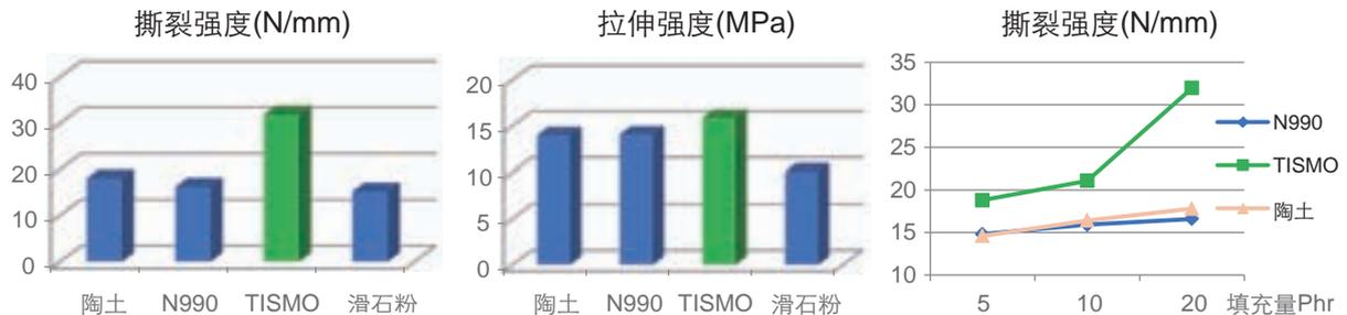
在氟橡胶中用低剪切混炼工艺填充TISMO，能够大幅度提高胶料的热撕裂强度和拉伸强度，同时橡胶的耐热性能也会得到改善。TISMO高填充时能够进一步提高氟橡胶的耐高温老化性能。建议用量在5~25phr。TISMO有优异的摩擦特性，尤其适用于高抗撕裂、耐高温的油封等产品。
